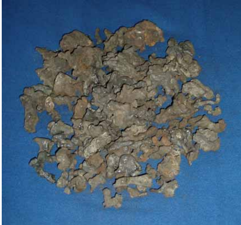
Figur 12. Stumper af jernslag (250G181), som er restproduktet efter jernudvinding. Cirklen er 20 cm i diameter.
