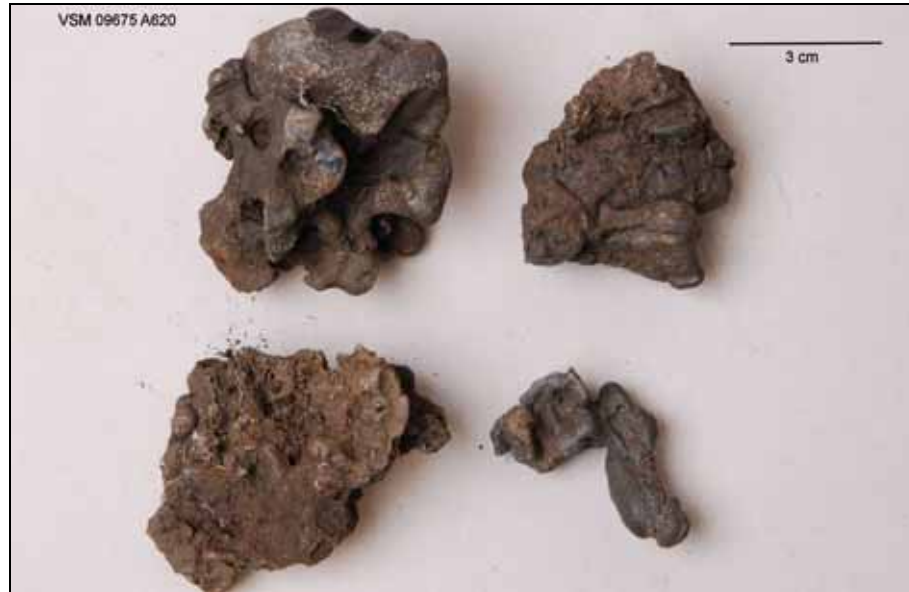
Figur 17. Udvindingsslagge fra slaggegrubeovn, som kan datere sig til tiden omkring Kristi fødsel til 600-tallet og dermed kan have sammenhæng med bebyggelsen fra yngre romersk til yngre germansk jernalder.
