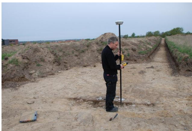
Figur 3. Opmåling af anlægsspor med RTK-GPS, der måler med en præcision bedre end 2 cm.
